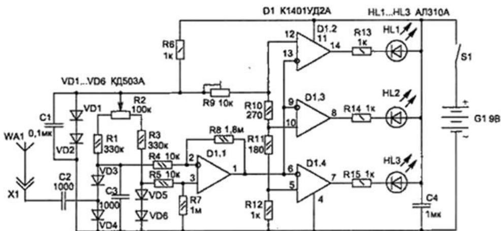
Юқорида келтирилган схема кенг полосали кўприкли РФ кучланиш детектори бўлиб, у 1 ... 200 МГц частота диапазонини камраб олади (микротўлқинли диапазонда VD1 ... VD6 диодларидан фойдаланилганда, ишчи диапазонни кенгайтириш мумкин) ва масофадаги радиоэшитгични аниқлаш имконини беради. тахминан 0,5 ... 1 м (бу транзиттернинг кучига боғлиқ).
